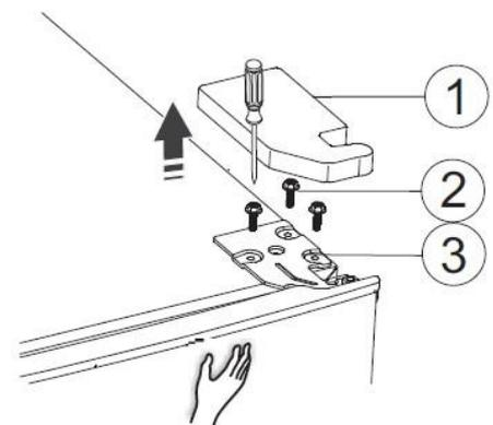
3. Coloque la tapa de la bisagra en la bolsa de plástico que contiene los demás accesorios, aparte los tornillos y la bisagra para su posterior montaje
