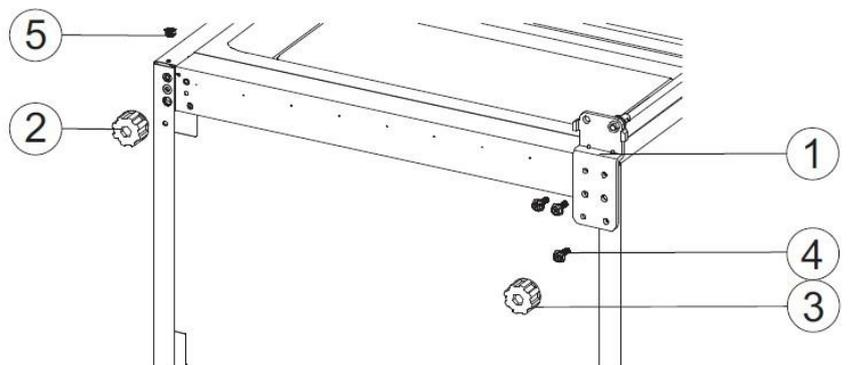
16. Desenrosque el perno de la bisagra y vuelva a atornillar en el orificio del tornillo del lado contrario.
