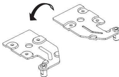
26. Retire la tapa del orificio del tornillo (1) en la parte superior izquierda y colóquela en el lado derecho (2).
