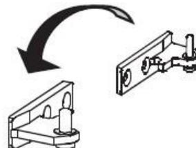
23. Coloque la bisagra central en la puerta inferior del equipo y atorníllela.
