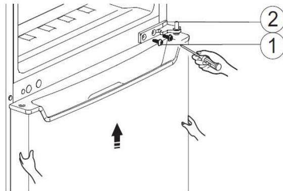
9. Afloje el tornillo (1) en la parte inferior de la puerta inferior del equipo.
