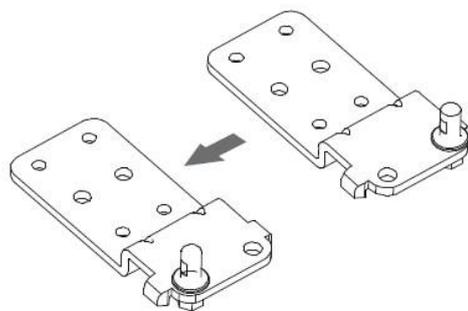
17. Fije la bisagra (1) a la izquierda con los tornillos (4) y atornille la pata (3)
