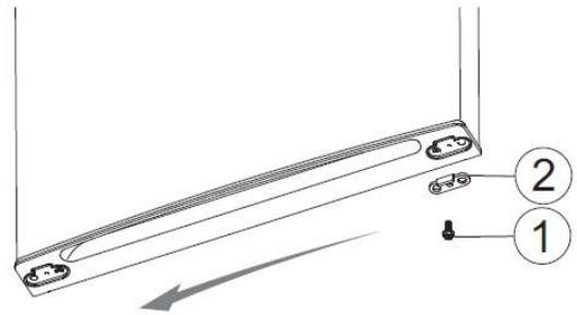
11. Retire las tapas de los orificios para tornillos a la izquierda y colóquelas a la derecha
