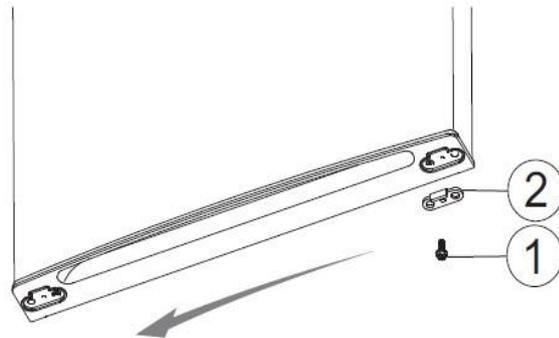
8. Afloje los tornillos (1) de la bisagra central y retire la bisagra (2). Abra la puerta inferior del equipo y haga palanca para sacarla de la bisagra inferior. Póngala a un lado con cuidado.
