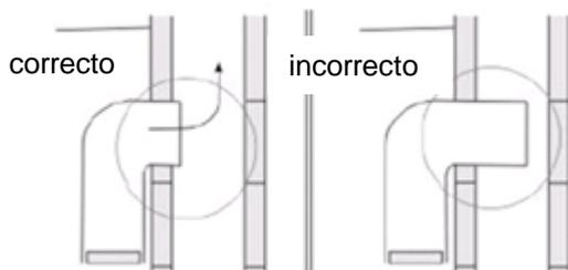
Cuando se conecta a un ducto de aire, la manguera de escape no debe introducirse demasiado dentro del ducto.
