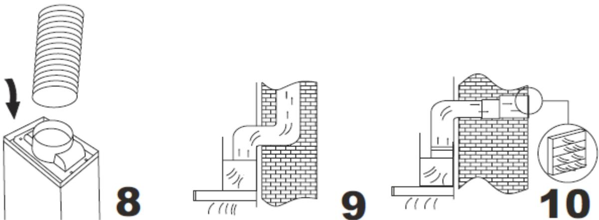
En el modo aspirante, los humos de la cocina se aspiran, se limpian a través del filtro de grasas y se descargan al aire libre a través de una manguera de salida de aire (no incluida en el volumen de suministro).
