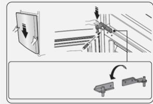
22. Coloque la puerta superior del equipo en la bisagra central y manténgala en su posición.
