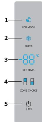
Ajuste la temperatura de tal forma que el aparato no enfríe constantemente, sin que haya una fase de descongelación. De ser así, la temperatura del frigorífico desciende (por debajo de 0 °C) y las bebidas y los alimentos frescos se congelan. Debido a la formación de hielo en la pared posterior, el consumo de energía aumenta mucho y la eficiencia del aparato disminuye.
