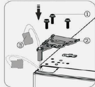
25. Conecte el cable (1) como se muestra y cúbralo con la tapa de la bisagra (2).
