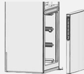
7. Destornille la bisagra inferior y la pata ajustable
